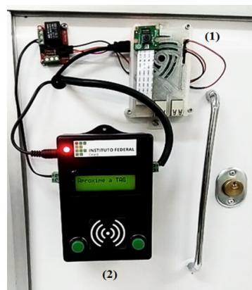
Fig. 7 Protótipo do sistema onde (1) é onde funciona todo o protótipo do reconhecimento e (2) é o sistema com tecnologia RFID. Fonte: Autor.
