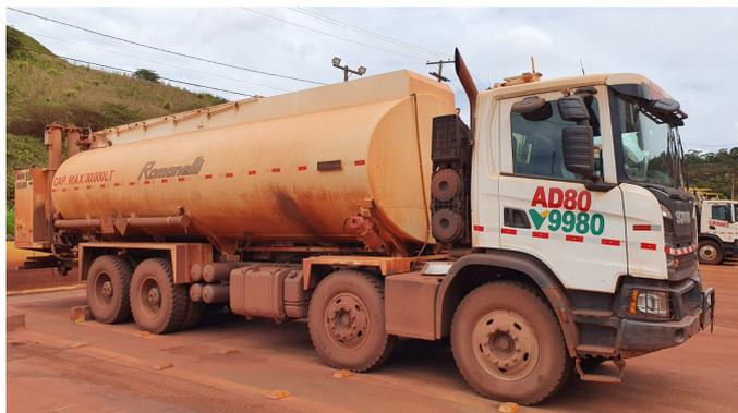
Figura 2. Comboio de 30.000 litros adaptado para abastecimento de equipamentos em campo.
