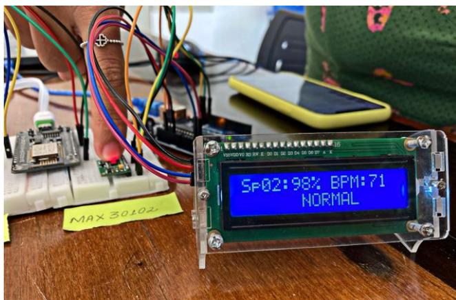
Fig. 12 Amostragem de dados monitorados através do sensor MAX30102.
