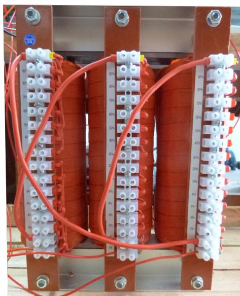
Figura 3. Enrolamento delta do transformador com os taps acessíveis.
