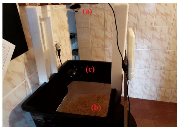
Figura 2: Configuração dos testes: (a) câmera na parte superior, perpendicular à área de teste; (b) área de teste adequada ao animal, com serragem, ração e água; e (c) módulo emissor com sensores embarcados
