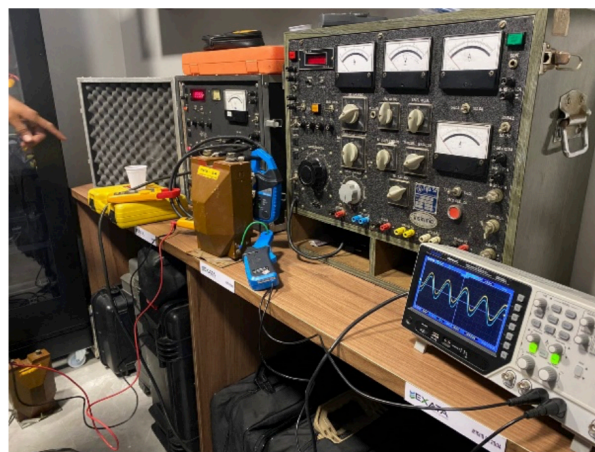
Figura 10. Bancada de ensaios para medição de erros de relação e ângulo.
