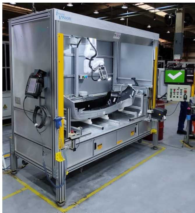
Figura 1. Célula de inspeção com robô Kuka KR4 R600.
