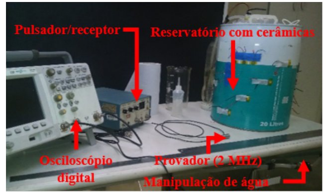
Figura 2. Visão geral da bancada experimental para os ensaios utilizando as técnicas de pulso eco e transmissão recepção.
