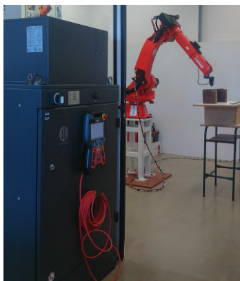
Figura 3. Robô Industrial utilizado e sua unidade controladora
