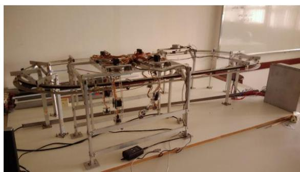
Figura 2. Maquete didática que simula linha de montagem automobilística
