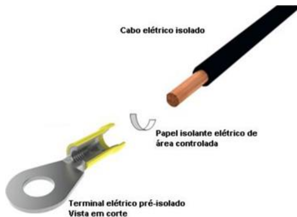
Fig. 2 - Manipulação da área de contato entre o cabo condutor e o terminal pré-isolado.
