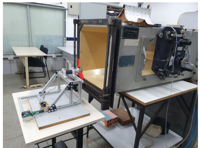
Figura 11. Microgerador durante testes em túnel de vento no LabTermo da UFSC. Fonte: original.
