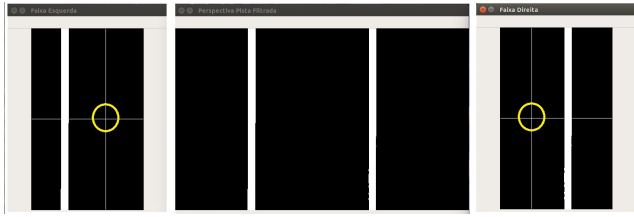
Figura 6. Pontos de interseção entre as bordas da pista, indicando que o robô está em linha reta.
