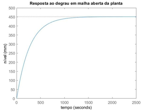
Figura 4 – Resposta ao degrau em malha aberta da planta
